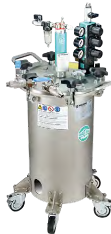
MDG 22 KLA mit pneumatischem Rührwerk Typ 46-810, Drucklufteinlass-armatur mit zwei zusätzlichen Reglern sowie Verteiler mit zwei Kugelhähnen zum Anschluss zweier Spritzpistolen. Für den mobilen Einsatz ist der Behälter mit Rollen und Handgriffen bestückt.
