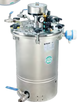
MDG 45 KLA mit pneumatischem Rührwerk Typ 46-735 sowie Schwinggabelsonde als Überfüllsicherung. Die Befüllung erfolgt über den unteren Hahn. Die beiden oberen Hähne dienen der Materialzirkulation – Vorlauf und Rücklauf.
