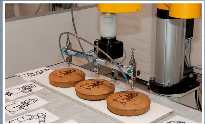
Lebensmittelverarbeitung mit Einzelpistolen am Roboter
